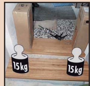
Nach 8 Min. können die Gewichte entfernt werden. Belastbar nach ca. 20 Min.
