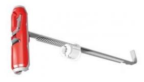
Der fischer Nylon-Kippdübel DUOTEC für hohe Zug- und Querlasten durch 2 Komponenten. Einfache Montage mit geringem Bohrlochdurchmesser von 10 mm und kurzem Kippelement auch in engen und gedämmten Hohlräumen. Einfache Vormontage, der Dübel fällt auch ohne Schraube nicht in das Bohrloch. Kein Einschneiden und damit Schwächung der Gipskartonplatte. Das Kippelement klappt hinter der Platte automatisch auf und gibt ihm seine
