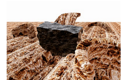
Siliziumcarbid-Körnung schneidet durch Hartholz.
