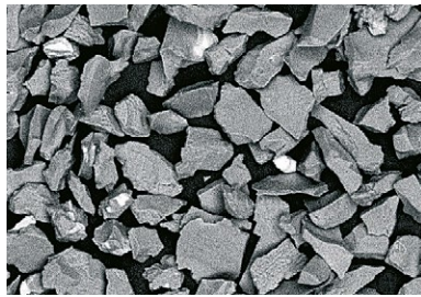
Vergrößerung von Aluminiumoxidkorn.
