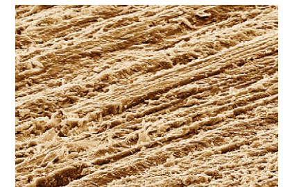
Holzoberfläche nach dem Schleifen mit Siliziumcarbid-Körnung.
