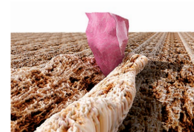
Aluminiumoxid-Körnung pflügt durch Weichholz.
