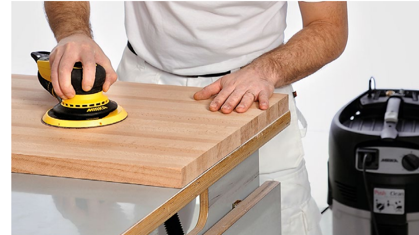
Schleifen von unbehandeltem Holz.
