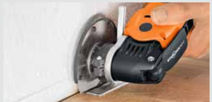
Dehnfugen lassen sich hervorragend nachschneiden.
