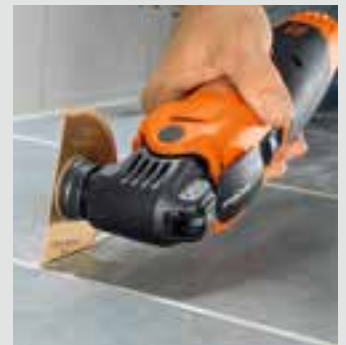
Mit den nur 1,2 mm breiten Sägeblättern lassen sich auch sehr schmale Fugen austrennen.
