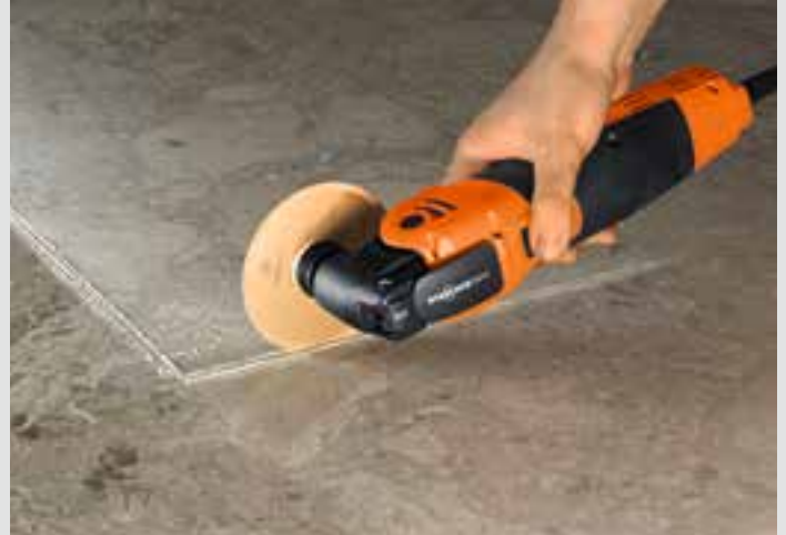
Das nur 1,2 mm breite Hartmetall-Sägeblatt für sehr schmale Fugen.
