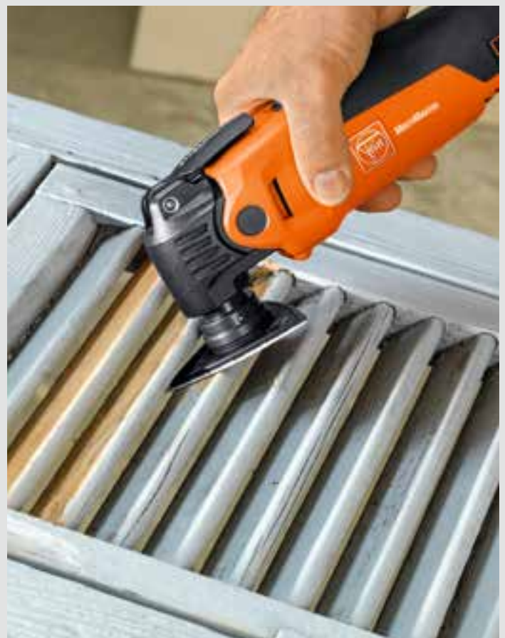
Flache Schleifplatte für enge Zwischenräume.
