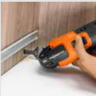
Kleinste Aussparungen ab 10 mm.
