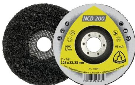
Klingspor Reinigungsscheiben eignen sich besonders für das Entfernen von Oberflächenverschmutzungen wie Farbe, Schweißnahtverfärbungen, Kleberüberläufen und Oxidationsschichten bei metallischen Werkstoffen. Die Reinigungsscheibe NCD 200 ist auf einem handelsüblichen Winkelschleifer einzusetzen
