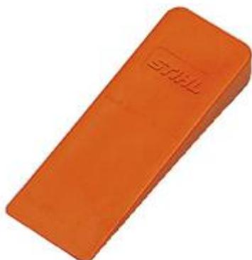
Aus schlagzähem Polyamid mit beidseitig führungssicherer Oberflächenstruktur. Länge 19 cm für mittleres Holz. Länge 23 cm für mittleres und stärkeres Holz. Länge 25 cm mit vergrößertem Keilwinkel. Zertifiziert durch den Forsttechnischen Prüfungsausschuss.
