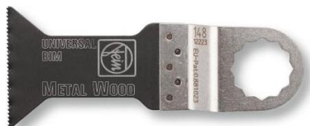
Mit BiMetall-Verzahnung, gekröpft, hohe Schnittgeschwindigkeit, Blech (400 N/mm<sup>2</sup>) bis ca. 2 mm, Alu-Profile, Cu-Rohre, Holz, Gipskarton und fast alle Kunststoffe. Länge 60 mm, Form 148.
