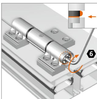
Hebespindel einschrauben, bis Lagerbuchse in Null-Stellung.
