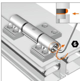
Hebespindel einschrauben, bis Lagerbuchse in Null-Stellung.
